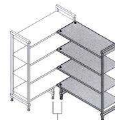
在每个基础架和扩展架下方使用一个衬垫座 Using one Dunnage Stand under each Starter and Add-on Unit.
